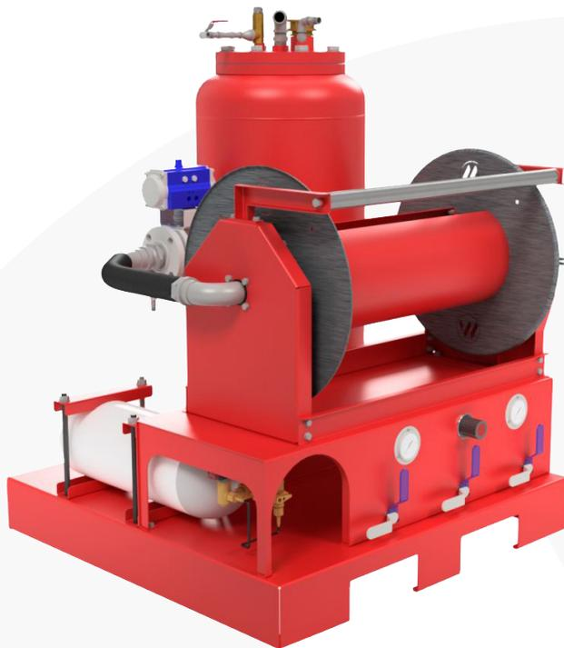
I materiali di costruzione del giunto girevole del naspo è fatto di materiale antifrizione come il bronzo con tenute composite **VITON + PTFE** con passaggi interni da **1"½**, con perdite di carico molto basse grazie allo studio della fluidodinamica interna effettuato da **MALECO**.
